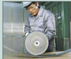
磨き加工 ヤスリ、サンドペーパー、スコッチペーパー等によるヘアライン仕上、墨による墨研ぎ仕上、ハンマーによる槌目仕上等、手加工による表面仕上げも行います。
