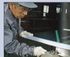
ボルト締め アーク溶接、酸素溶接、ロー付け、摺り合わせ、嵌め込み、部品組込み、ネジ止め等の作業も行います。
